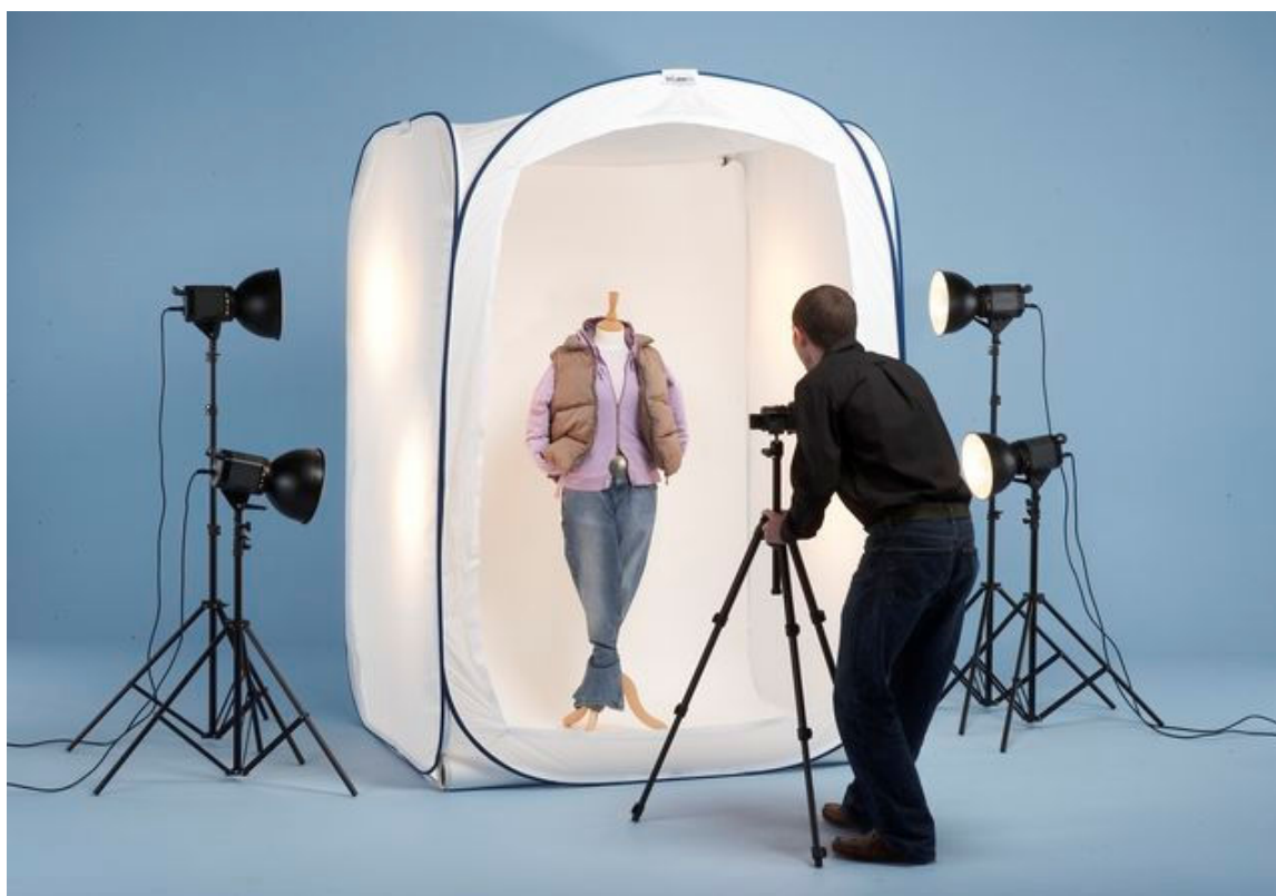
Belysning med 4 stk. lamper, 2 til baggrundsbelysning og to placeret som sidelys
